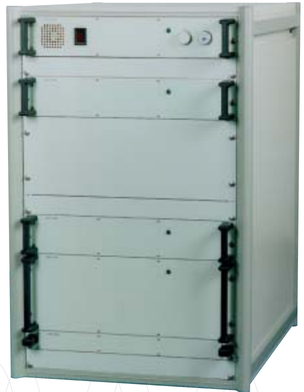
Stationäre Funkstation mit mehreren Transceivern, versorgt aus Netzspannung
