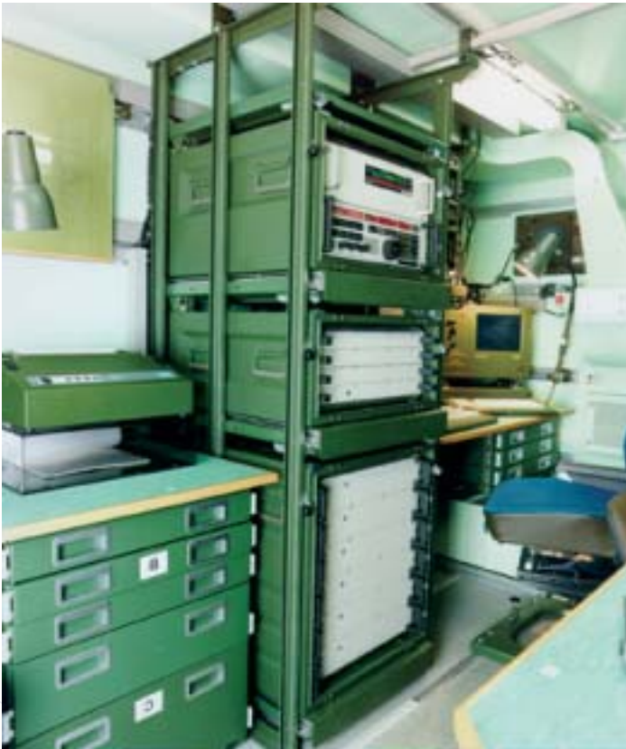
Semimobile Funkstation mit mehreren Transceivern, versorgt aus 24 VDC Bordnetz
