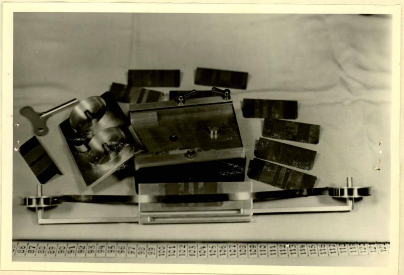
Schnellgeber zerlegt in seine Einzelteile. Unteres Bild mit Hilfsmitteln.
