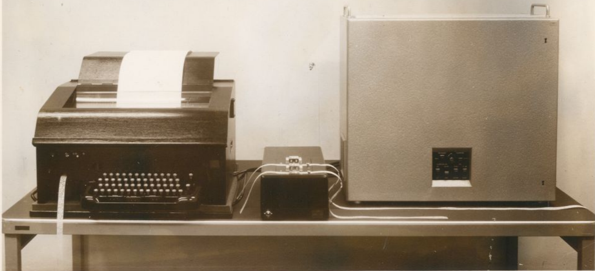
Poste crypto graphique comprenant "Ecolex I Philips Usfa" numéro de type Us 8000, avec émetteur pas à pas et téléimprimeur.
